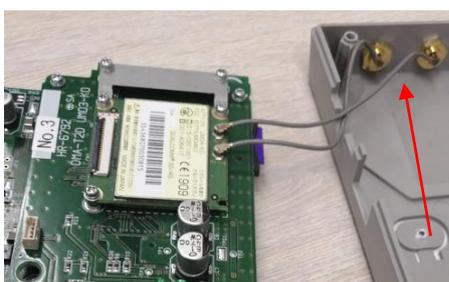
注意！！上面のケースから基板を外さないこと。外れた場合は、左図のアンテナケーブルが引っ張られてしまいますので、ケーブルのコネクタが抜けないよう十分注意してください。
