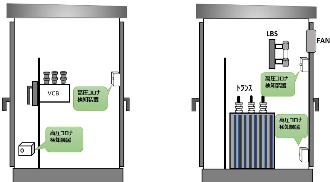
図. 6 高圧受変電設備内 配置場所例
