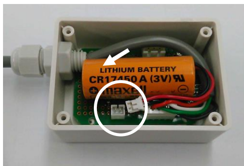
電池のコネクタを基板コネクタに取付ける
