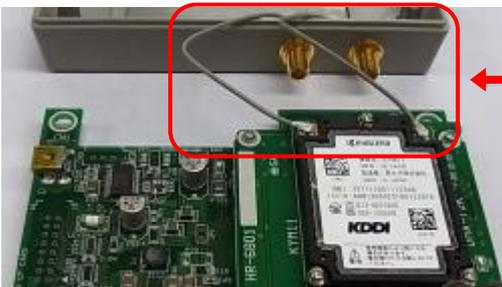
アンテナ線に注意して、表面ケースから基板を外します。
