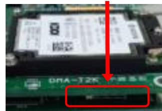
(4) nano SIM カードをカードスロットへ挿し込みます。
